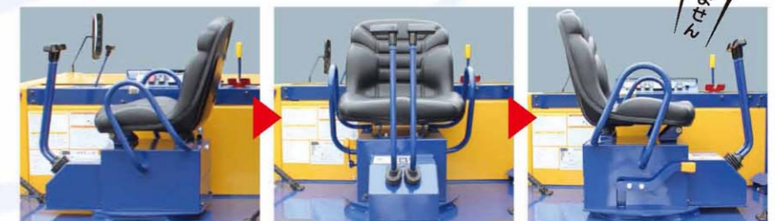
操作部を集中配置しているので座席を反転させても操作・確認が容易に行えます。
