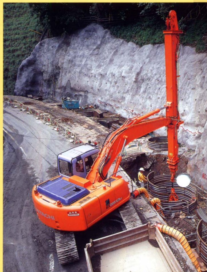
EX225USRLC 無線式リモコンシステム仕様 (後端旋回半径：2,000mm)
